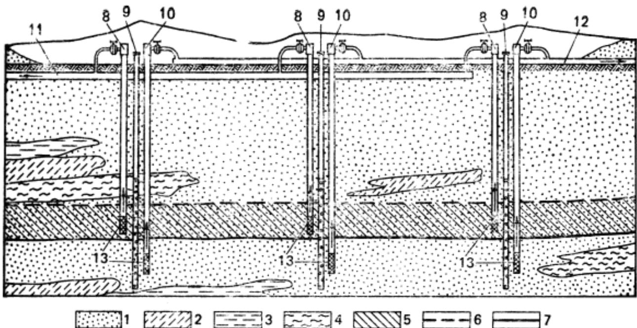
Схема промышленного отбора пресных вод из подпесчаной линзы спаренными скважинами:
