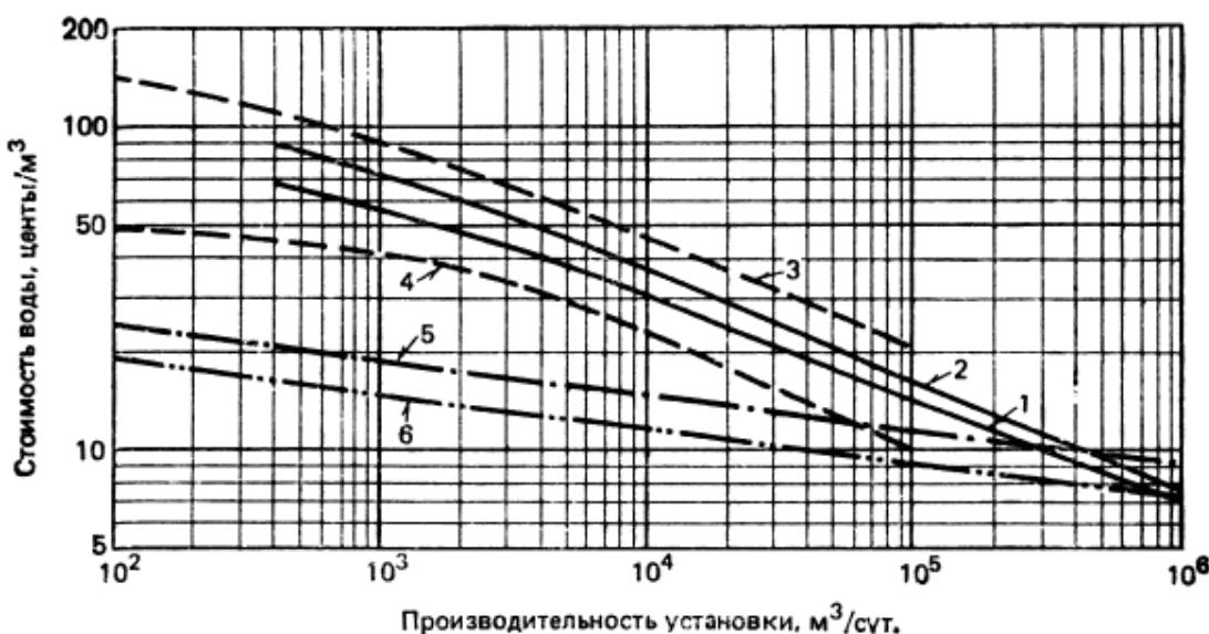
Зависимость стоимости орошения воды на зарубежных установках разного типа от их производительности:
