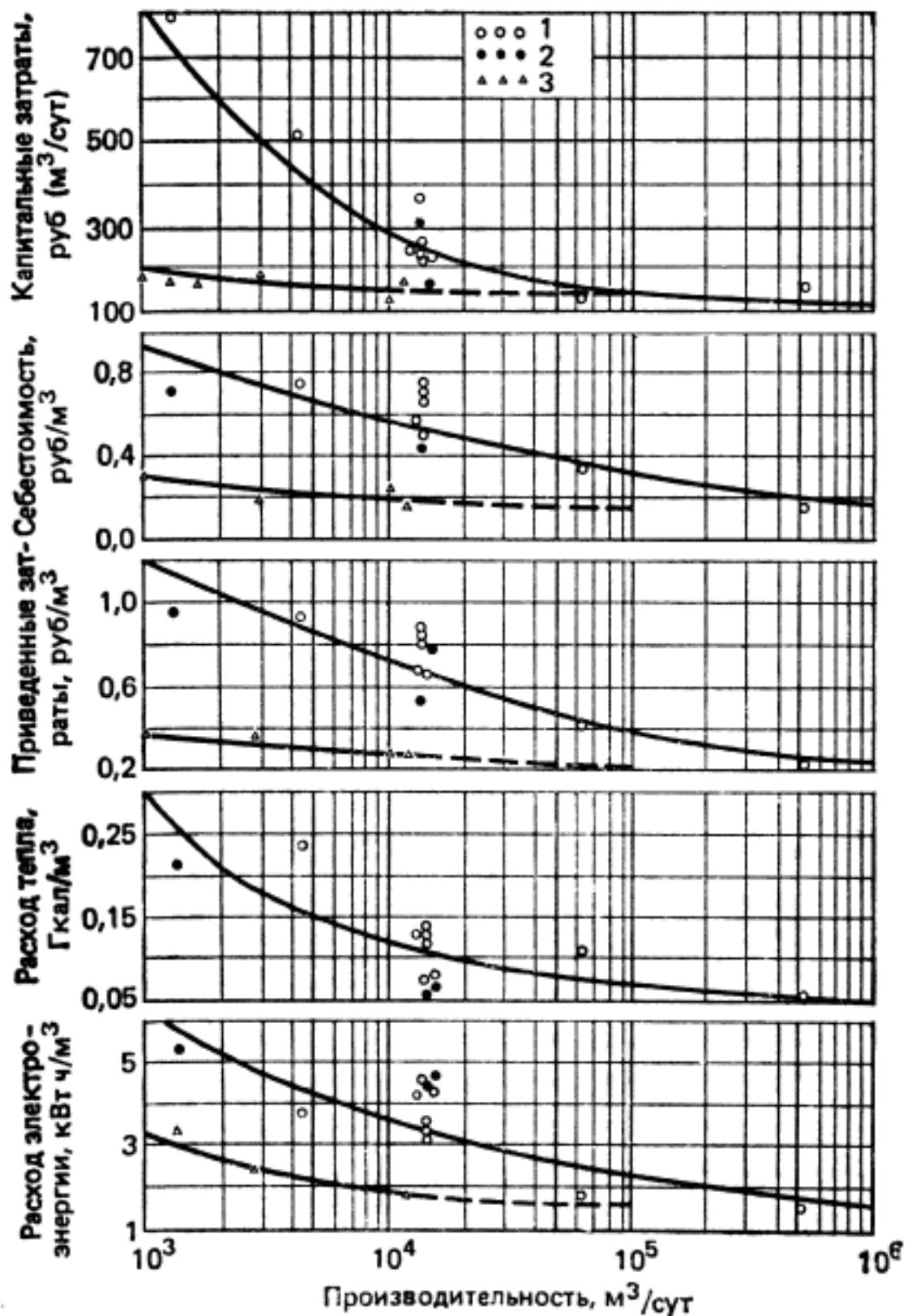
Материальные и энергетические затраты в СССР на оросение воды в зависимости от типа и мощности установки:
