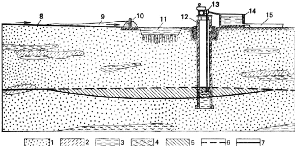
Схема искусственного формирования линзы пресных вод и водозаборного колодца:
