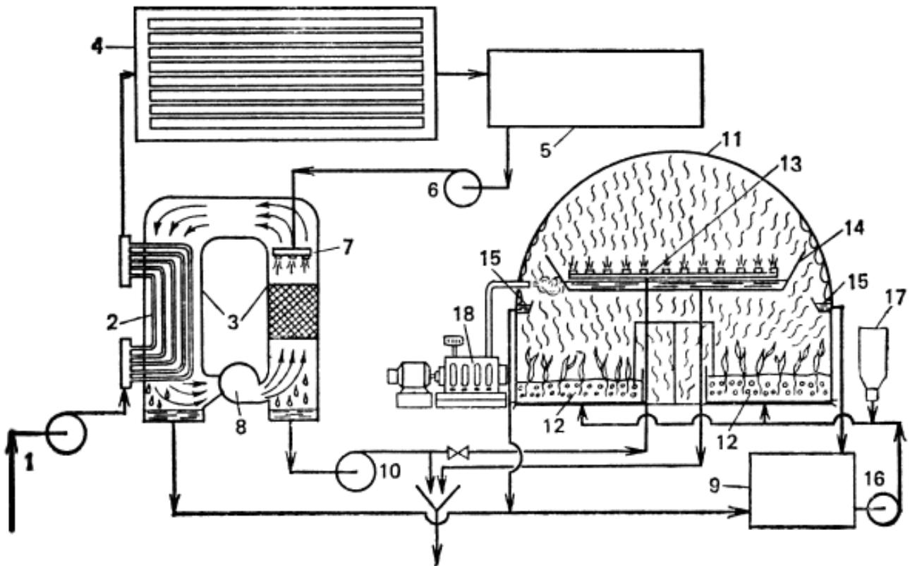
Схема солнечного увлажняющего опреснителя и гелиотеплицы с контролируемой средой:
