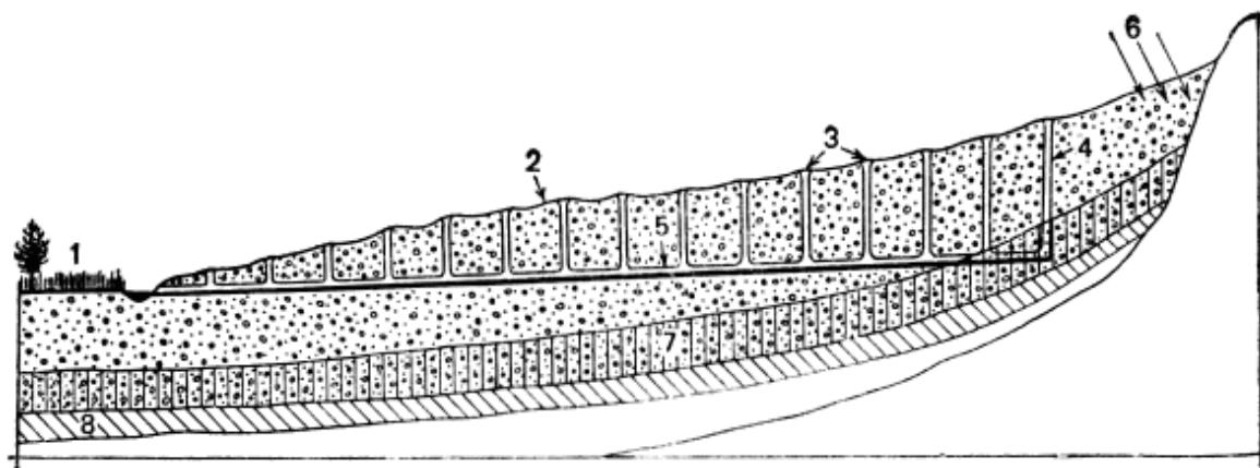
Схема подземной водосборной галерей (кяриза):
