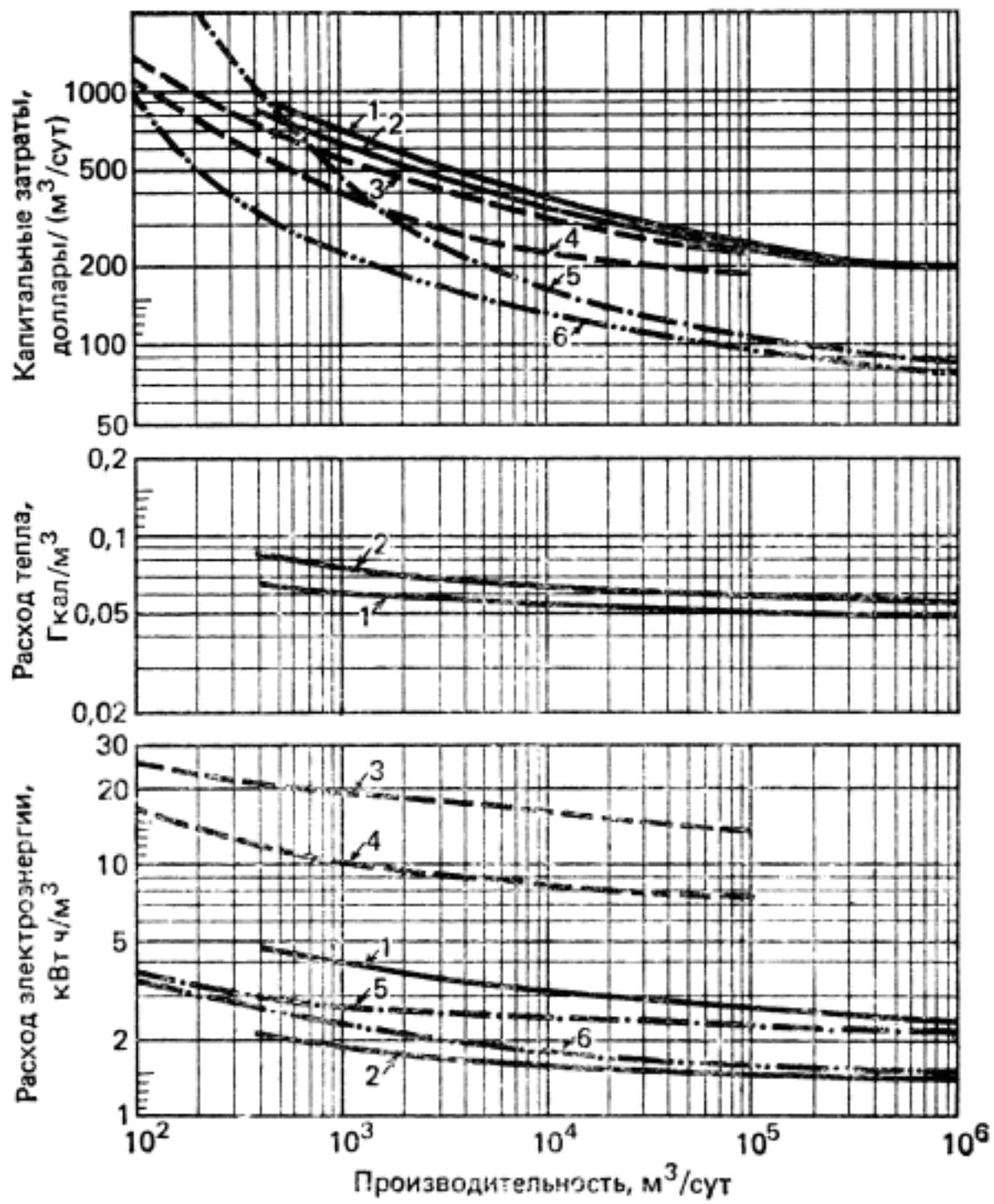
Изменение удельных экономических и энергетических показателей орошения воды на установках разного типа и производительности (по зарубежным данным):
